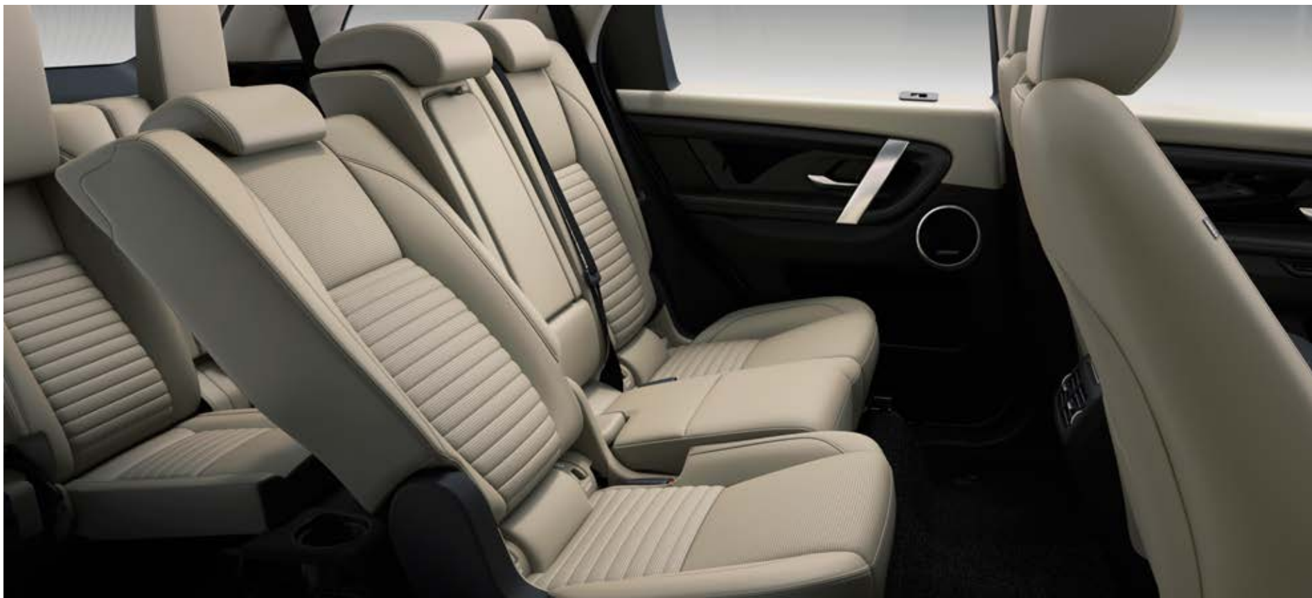
60:40分割可倒式2列目シート（スライド&リクライニング機能付）
