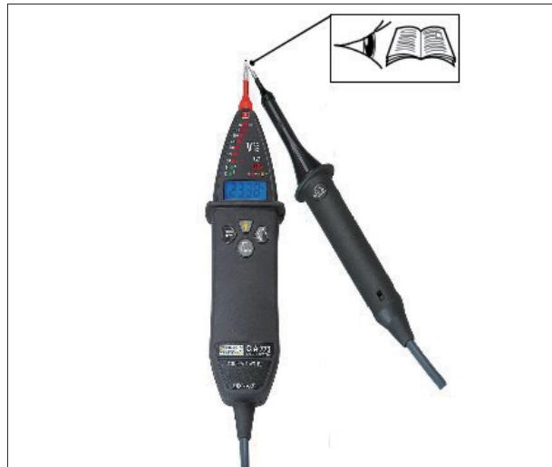
39. 電圧テスト機器は、電圧検証ユニットを使用してテストする必要がある。
