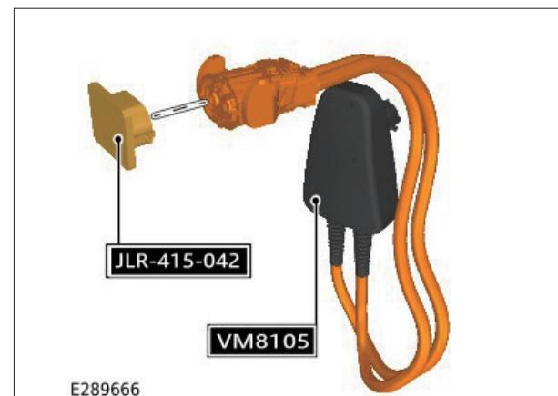
34. 図に示すように、安全チェック コネクタをブレーク アウト ボックス (VM8105) に取り付ける。
