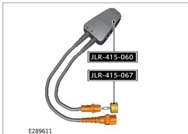
50. 図に示すように、安全チェック コネクタをブレーク アウト ボックス (JLR-415-060) に取り付ける。
