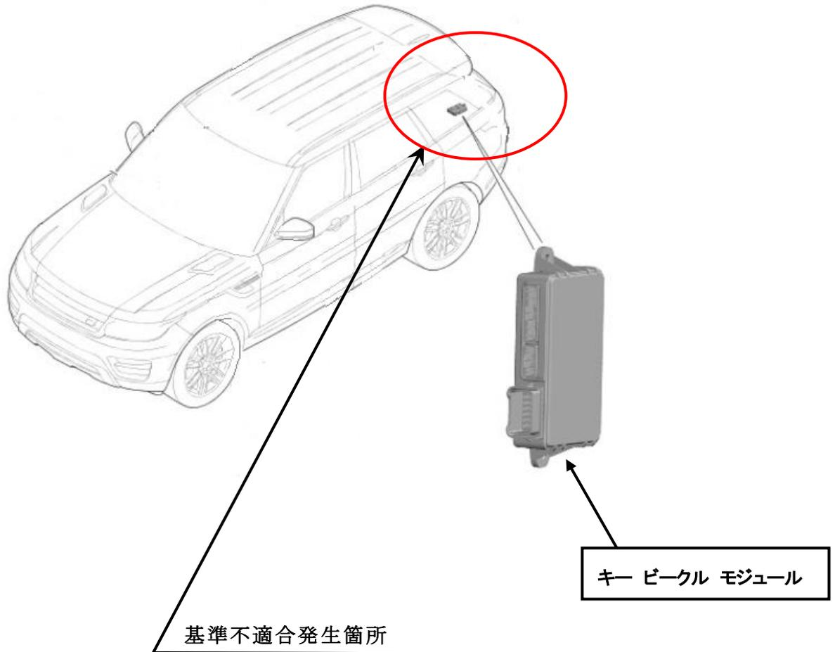
後席の乗降扉において、施錠・開錠を制御しているコントロールモジュールのプログラムが不適切なため、リモコンで自動的にドアを開放しようとした際、ドアラッチ機構が錆びて作動抵抗が大きいと、当該コントロールモジュールからドアラッチ機構へ供給される電流が閾値を超えドアラッチを作動させるモータが停止することがある。そのため、ドアラッチが施錠以外の状態で固定され、ドアを閉めても確実にロックされず、最悪の場合、走行中に扉が開くおそれがある。
