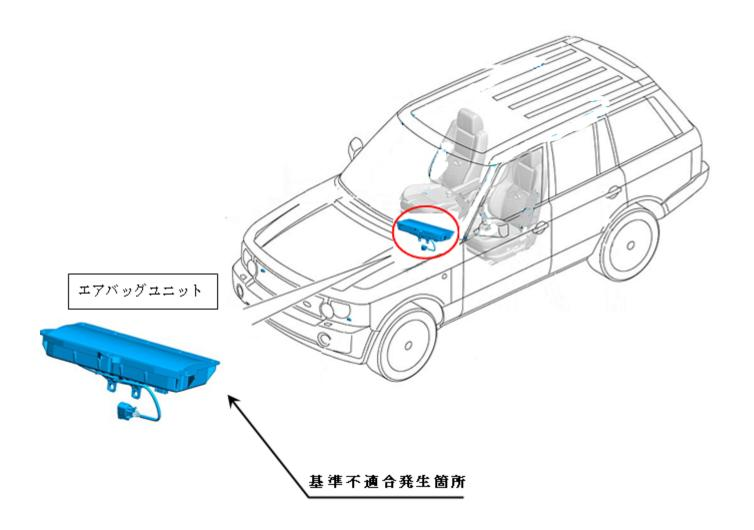
助手席用エアバッグのインフレータ(膨張装置)において、ガス発生剤の吸湿防止が不適切であった場合、高い湿度の環境下で温度変化を繰り返すと、ガス発生剤が劣化することがある。そのため、エアバッグ展開時にインフレータ容器が破損するおそれがある。
