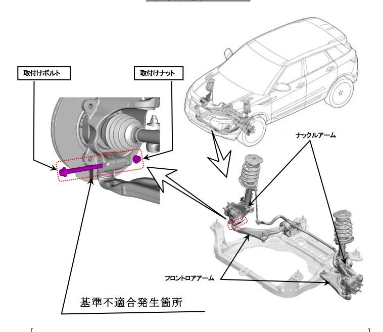
緩衝装置において、フロントロアアームの組付時の作業指示が不適切なため、当該アームとナックルアームを締結するボルトの軸力が不足しているものがある。そのため、走行時に異音が発生し、そのままの状態で使用を続けると、 走行振動等により当該ボルトが折損し、最悪の場合、フロントロアアームが外れ、走行不能となるおそれがある。
