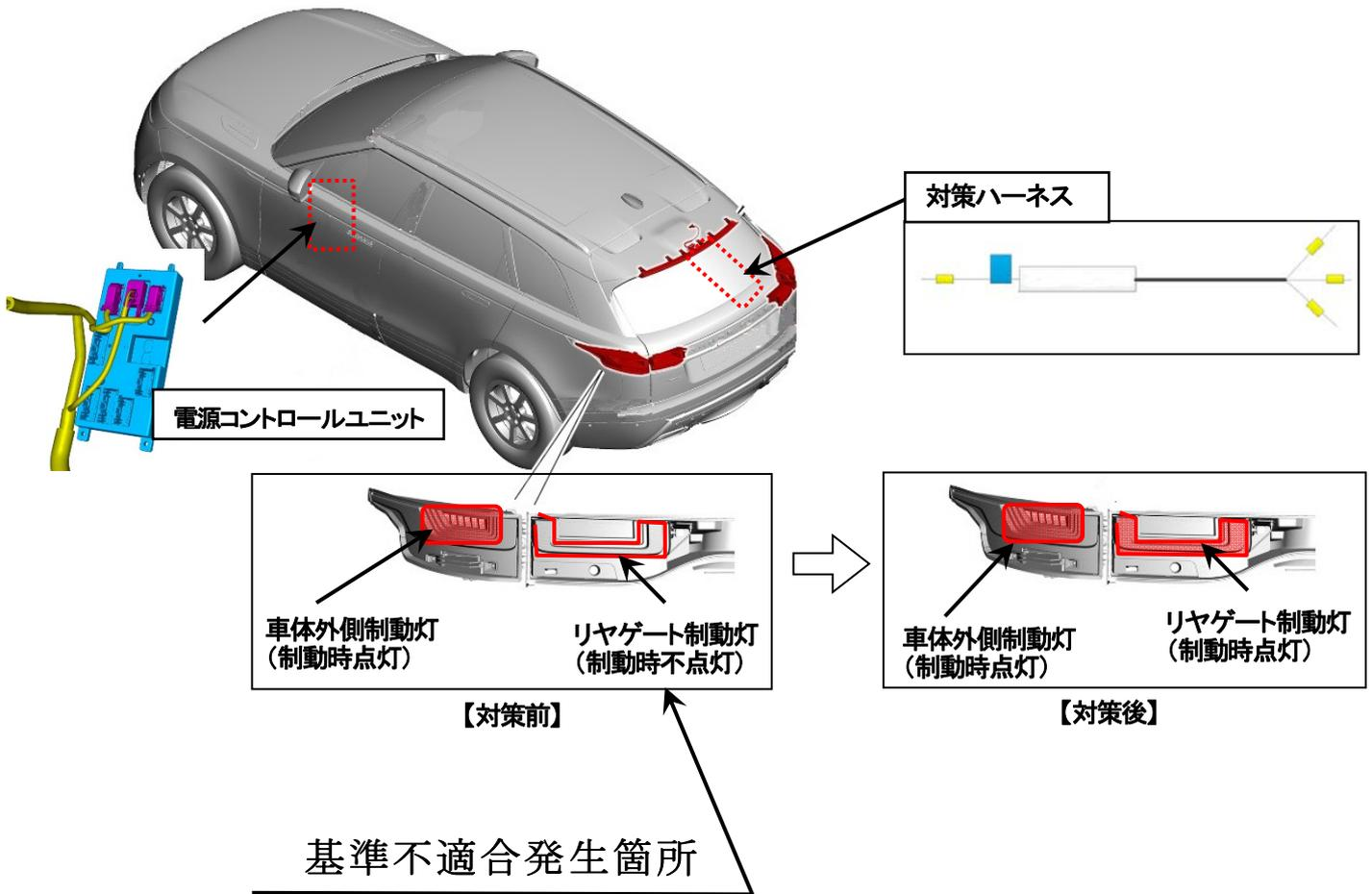
制動灯において、電気回路の設計が不適切なため、リヤゲート部に取り付けられた制動灯が点灯しない。そのため、保安基準第39条の基準に適合しない。
