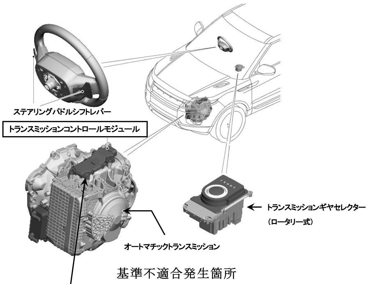
〔トランスミッションコントロールモジュールのプログラムが不適切なため、シフト制御用センサー配線接続端子の製造上のばらつきによる電気抵抗変化を異常として検知することがある。そのため、走行中に警告灯が点灯し、ギヤがニュートラルになり走行不能となるおそれがある。〕
