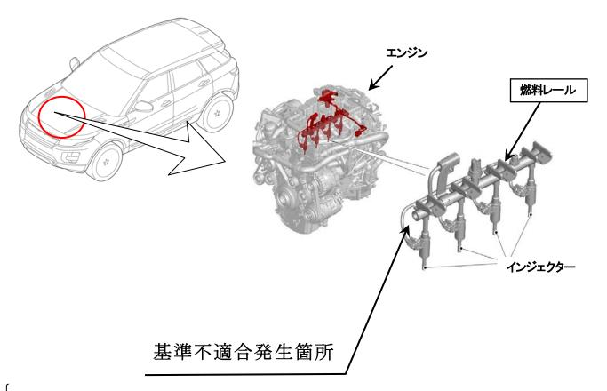
燃料レールの製造工程において、燃料レールエンドキャップのロウ付け加工が不適切なため、ロウの割れが発生するものがある。そのため、当該部位から燃料がにじみ、最悪の場合、火災に至るおそれがある。
