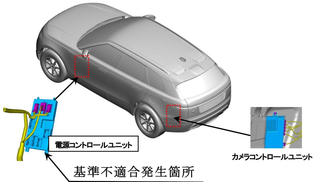
直前直左カメラの画像表示装置において、カメラコントロールユニットを最新プログラムに更新したものについて、電源コントロールユニットプログラムとの互換性が不適切なため、ギア位置をDレンジにした際に、車両の画像が表示しなくなる。そのため、直前直左の視界が確保できなくなる。
