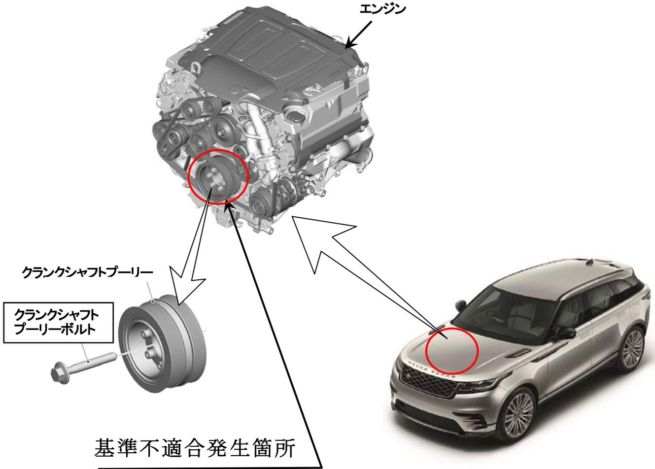
V型6気筒および8気筒エンジンにおいて、クランクシャフトプーリーボルトの表面仕上げが不適切なため、当該ボルトの強度が不足しているものがある。そのため、走行振動等により当該ボルトが破損し、クランクシャフトプーリーが外れ、警告灯が点灯し、最悪の場合、走行不能になるおそれがある。
