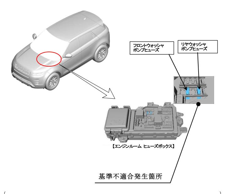
フロント及びリヤウィンドウォッシャポンプにおいて、使用環境に対する電気回路の容量設定が不適切なため、ウォッシャノズルが凍結した状態でウォッシャを使用すると、フロント及びリヤウィンドウォッシャポンプ回路のヒューズ が切れることがある。そのため、ウォッシャ液が噴射されなくなるおそれがある。
