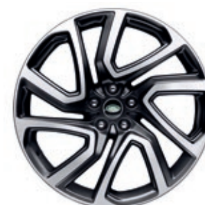
22インチスタイル5025 アロイホイール (5スプリットスポーク、サテンダークグレイ ダイヤモンドターンドフィニッシュ) (2)
