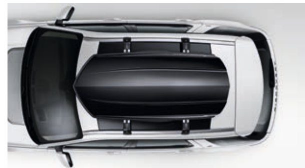
ルーフボックス* VPLWR0100 – ラージスポーツルーフボックス* (写真) VPLVR0061 – スポーツルーフボックス* VPLVR0062 – ラグジールーフボックス* 各種サイズをそろえたルーフボックスは、すべてが車の左右両側から開閉が可能です。セキュリティを高めるインテグラルロック付。積載容量はスポーツボックスの320リッターからラグジールーフボックスの410リッター、ラージスポーツボックスの430リッターまでとなります。
