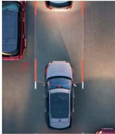
**レーンキープアシスト&ドライバーコンディションモニター**
