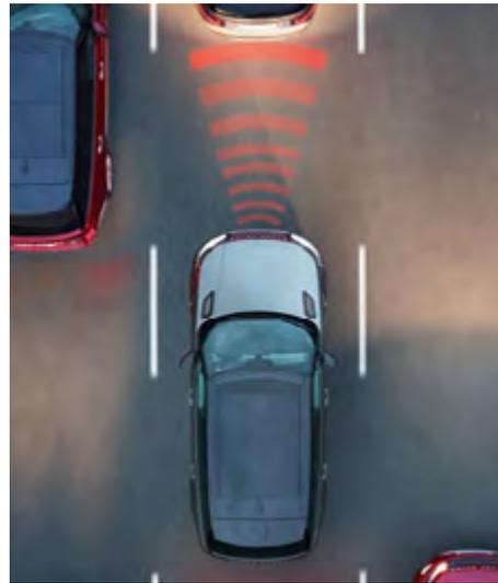
**ACC (アダプティブクルーズコントロール) キューアシスト機能、インテリジェントエマージェンシーブレーキ付**
