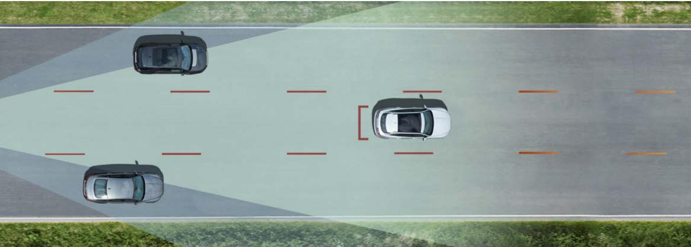
アダプティブクルーズコントロールは、走行速度20km/h、もしくはクルーズの「設定」ボタンで起動可能。0~200km/hでの走行中は継続して作動します。その間、カメラとレーダーが連動して先行車と走行レーンを監視。運転中の車両をレーン中央に維持し、先行車の挙動に応じて、速度を適切に調整します。先行車が速度を落としたら車両を減速。先行車が停止したら、必要に応じて停車させます。混雑した道路状況でも、リラックスしてドライブをお楽しみいただけます。
