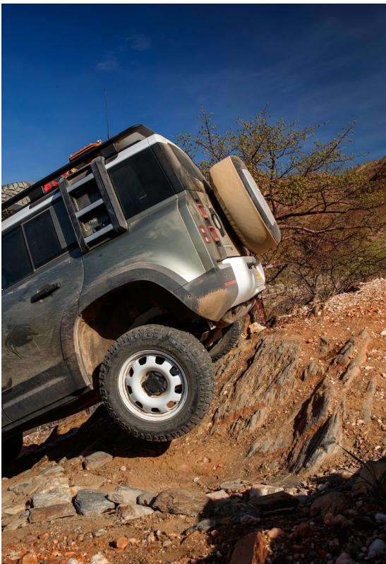
採用するが、ヨーロッパと北米仕様にはこれに加えて3ℓマイルドハイブリッド6気筒ガソリンが、さらにヨーロッパでは2ℓディーゼルも用意される。トランスミッションは8段ATが標準。サスペンションは四輪独立で、リジッドアクスルだった旧型とシャープなコントラストを見せる。
